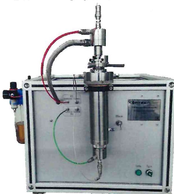
Рисунок 1 – Общий вид установки для измерения пористости и проницаемости СМП-ПП
